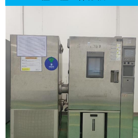
恒温恒湿保存槽
